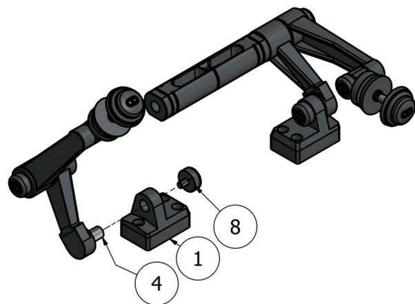
1- Retire el tornillo (8) y el eje de brazo (4).
